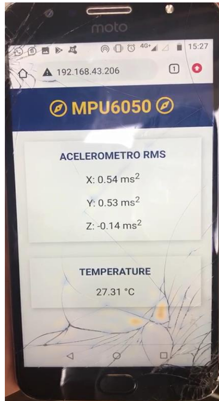
Figura 36: Dados coletados pelo acelerômetro exibidos na interface do smartphone .
