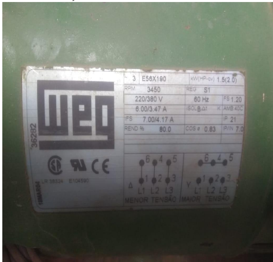
Figura 32: Placa motor de indução trifásico 1.5CV.
