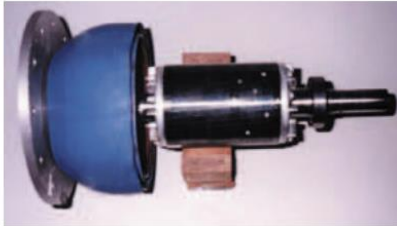
Figura 6: Exemplo da simulação de um rotor com barras quebradas.
