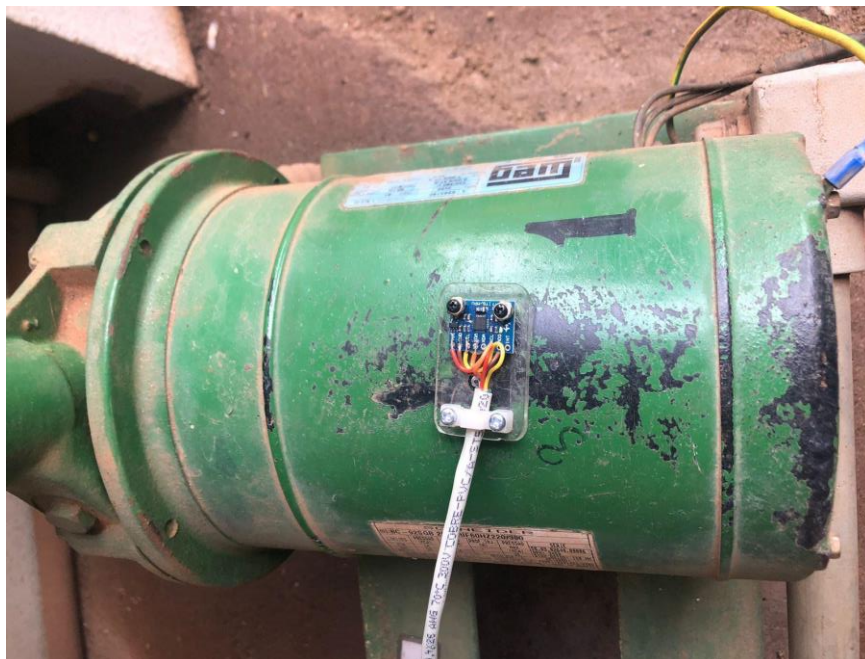
Figura 35: Posicionamento do sensor ao motor.
