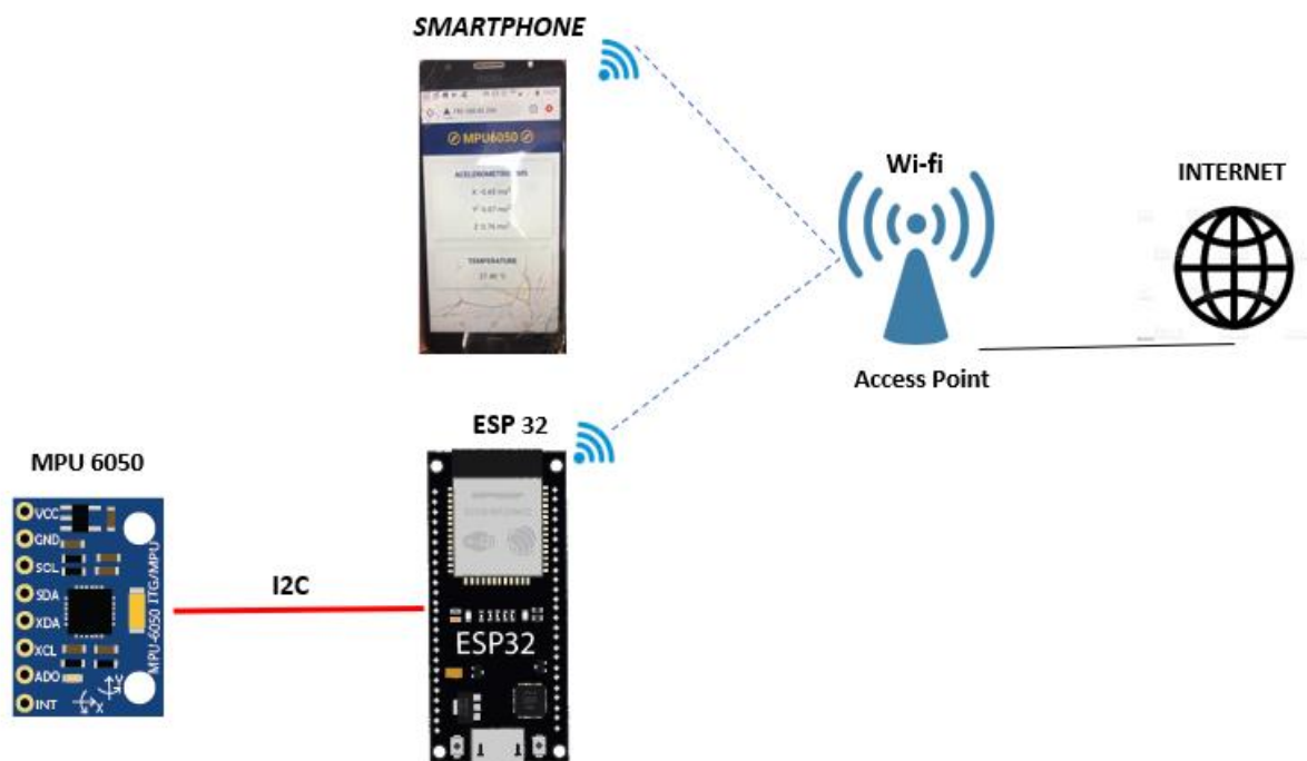
Figura 23: Estrutura de comunicação entre hardwares.
