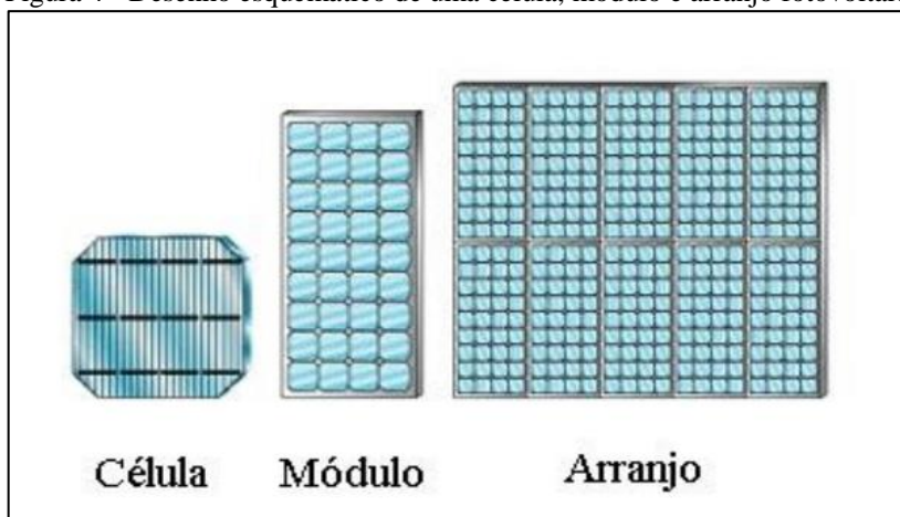
Figura 4 - Desenho esquemático de uma célula, módulo e arranjo fotovoltaico
