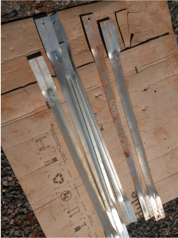
Figura 13 – Falhas por conta da galvanização
