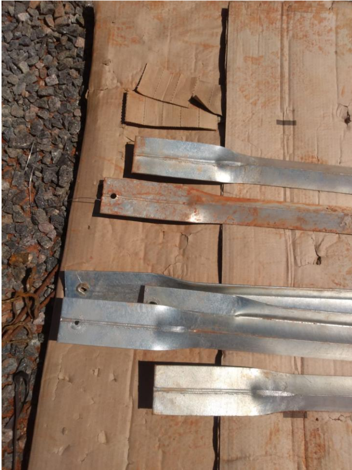
Figura 15 – Falhas por conta da galvanização
