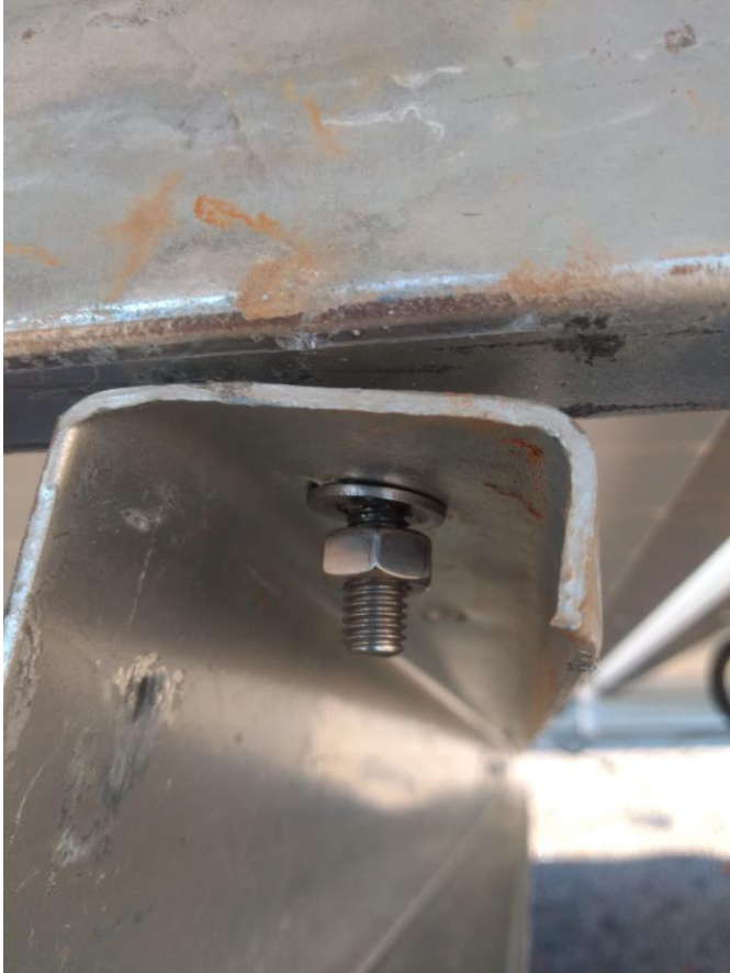
Figura 30 – Parafuso do braço longitudinal sem torque
