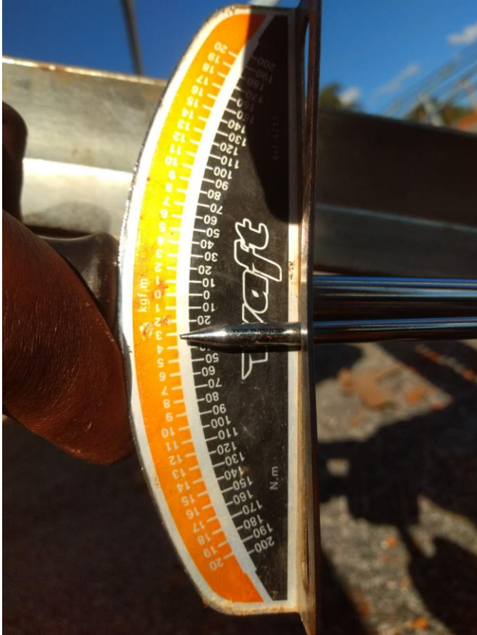
Figura 31 – Conferência do torque aplicado
