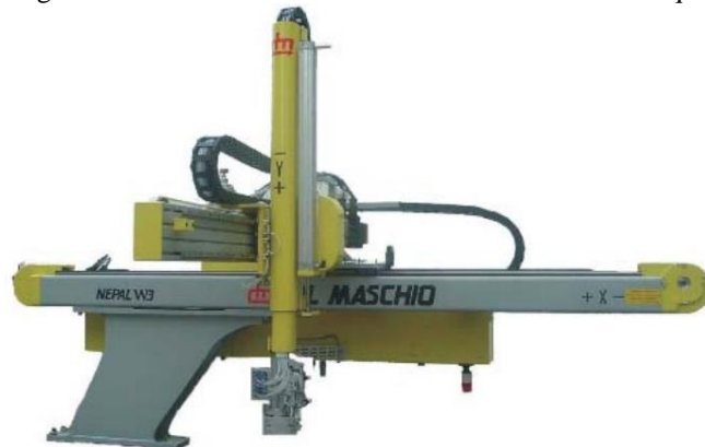
Figura 13: Robô da marca Dal Maschio utilizado em máquinas injetoras.
