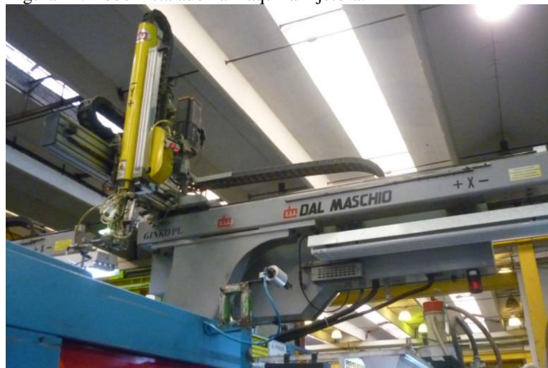
Figura 14: Robô instalado na máquina injetora.
