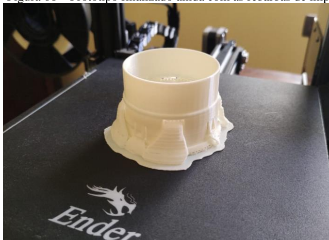
Figura 06 – Protótipo finalizado ainda com as rebarbas de impressão.
