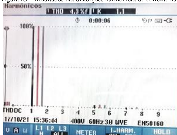
Figura 23 – Resultados das distorções harmônicas de corrente na partida estrela-triângulo.
