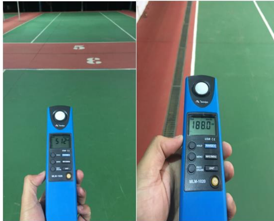
Figura 21 - Medição em LUX no ginásio.
