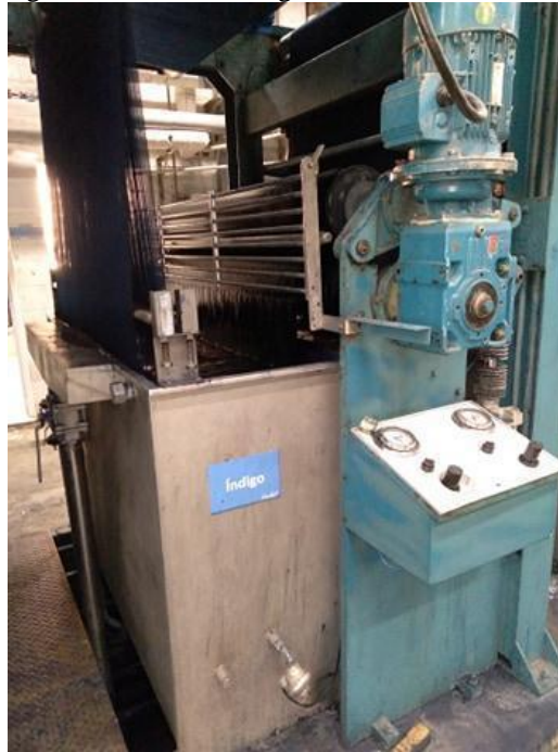
Figura 17 - Caixa de tingimento.
