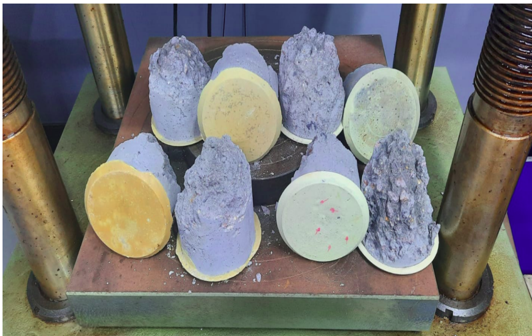
Figura 7 - Testemunhos rompidos capeados com enxofre (à esquerda) e capeados com resina (à direita).
