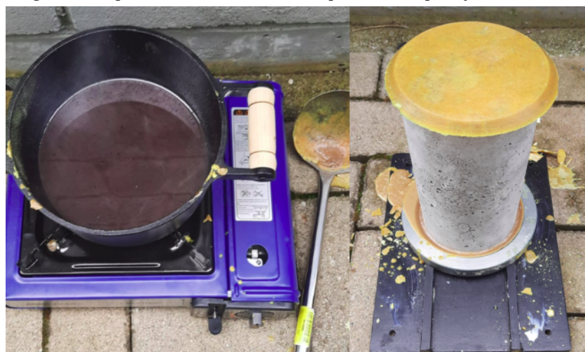
Figura 6 - Capeamento com enxofre, temperatura de aplicação 150°C
