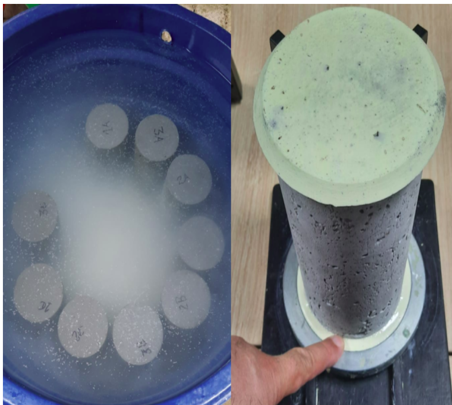
Figura 5 - Caixa para cura úmida (à esquerda) e capeamento feito com resina a temperatura ambiente (à direita)
