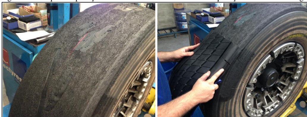
Figura 6 - A esquerda aplicação da cola vulcanizadora e a direita a aplicação da banda de rodagem.
