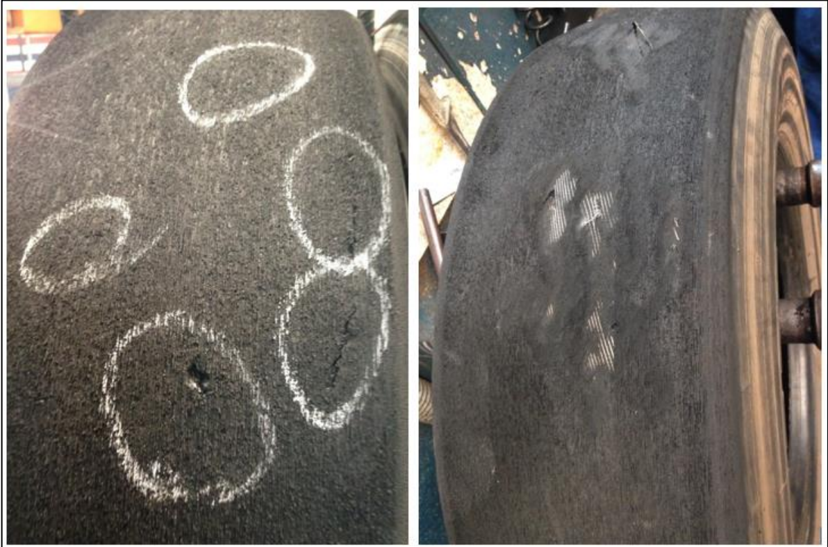
Figura 4 - A esquerda as avarias demarcadas e a direita as avarias escareadas.
