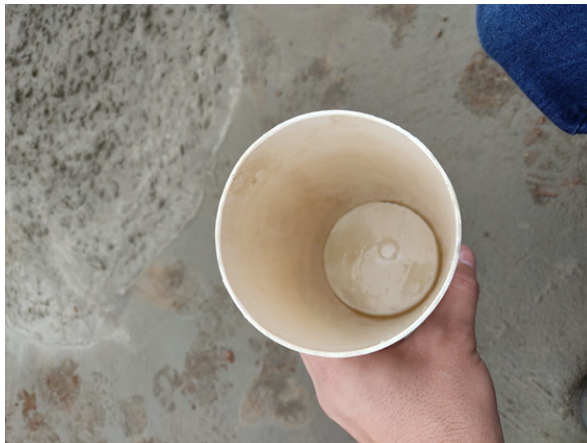
Figura 3: Molde preparado para recebimento do concreto.
