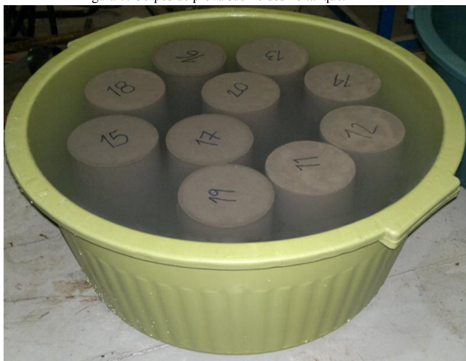
Figura 7: Corpos de prova submersos no tanque.
