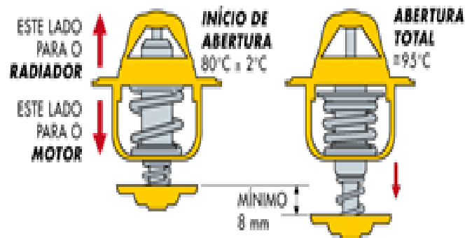
Figura 5 Ilustração do funcionamento da Válvula Termostática
