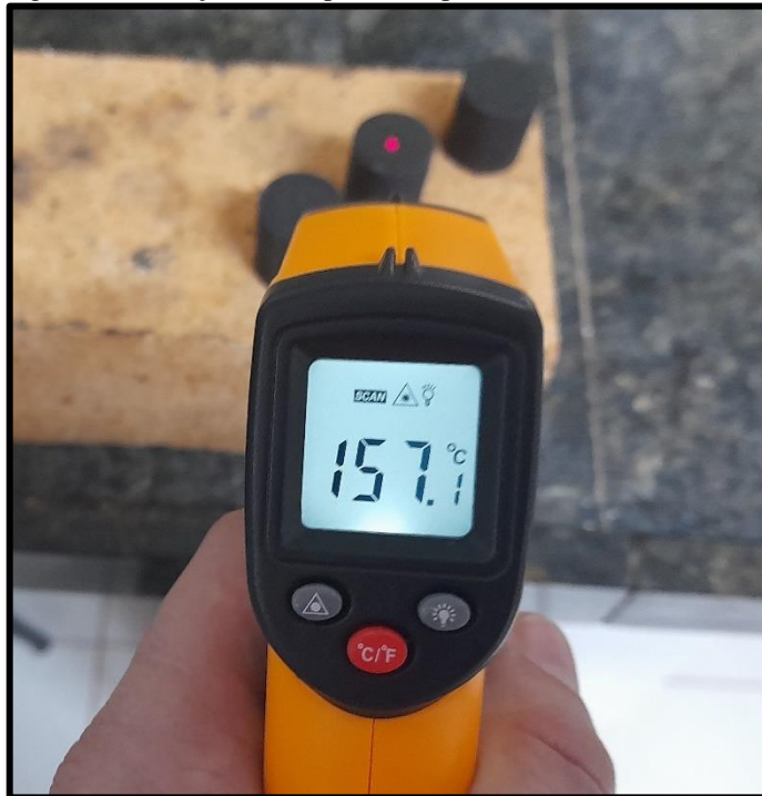
Figura 9 – Medição de temperatura após o resfriamento.
