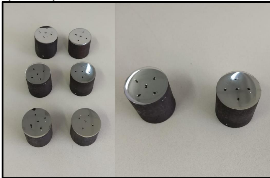
Figura 13 – Imagens das amostras testadas no ensaio de dureza.
