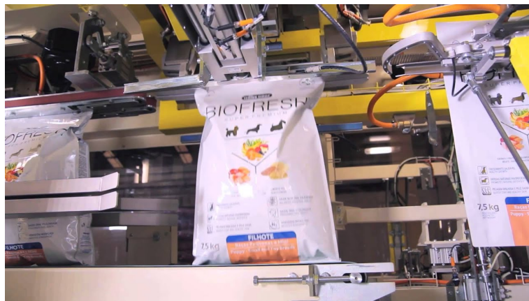
Figura 13. Processo de Embalagem de Rações para cães e gatos.
