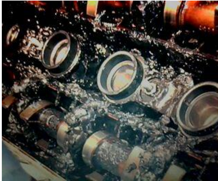
Figura 4 - Borra de carbonização do motor AT-16V
