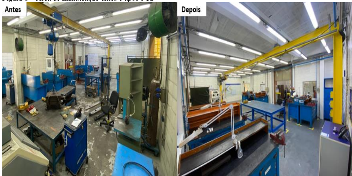
Figura 6 – Área de manutenção antes e após o 5S
