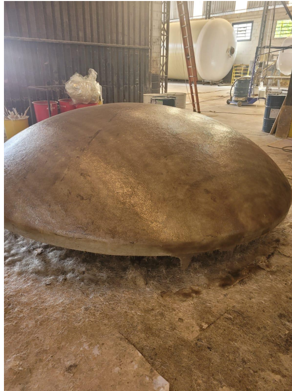
Figura 19- Tampo laminado pelo método Spray-up
