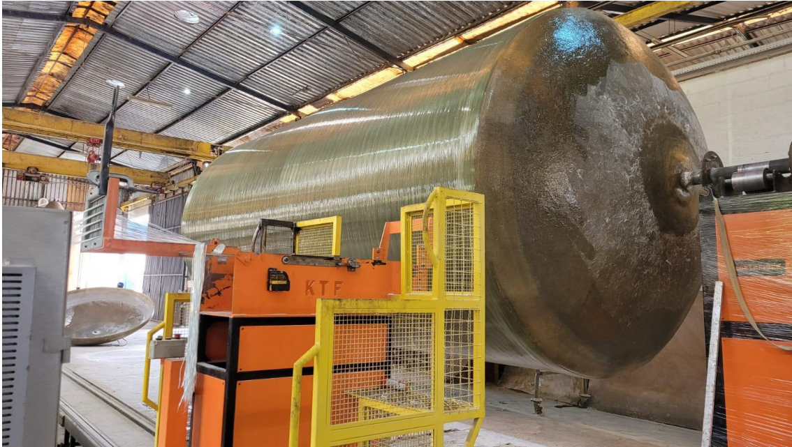
Figura 23- Corpo do reservatório montado recebendo estruturação.
