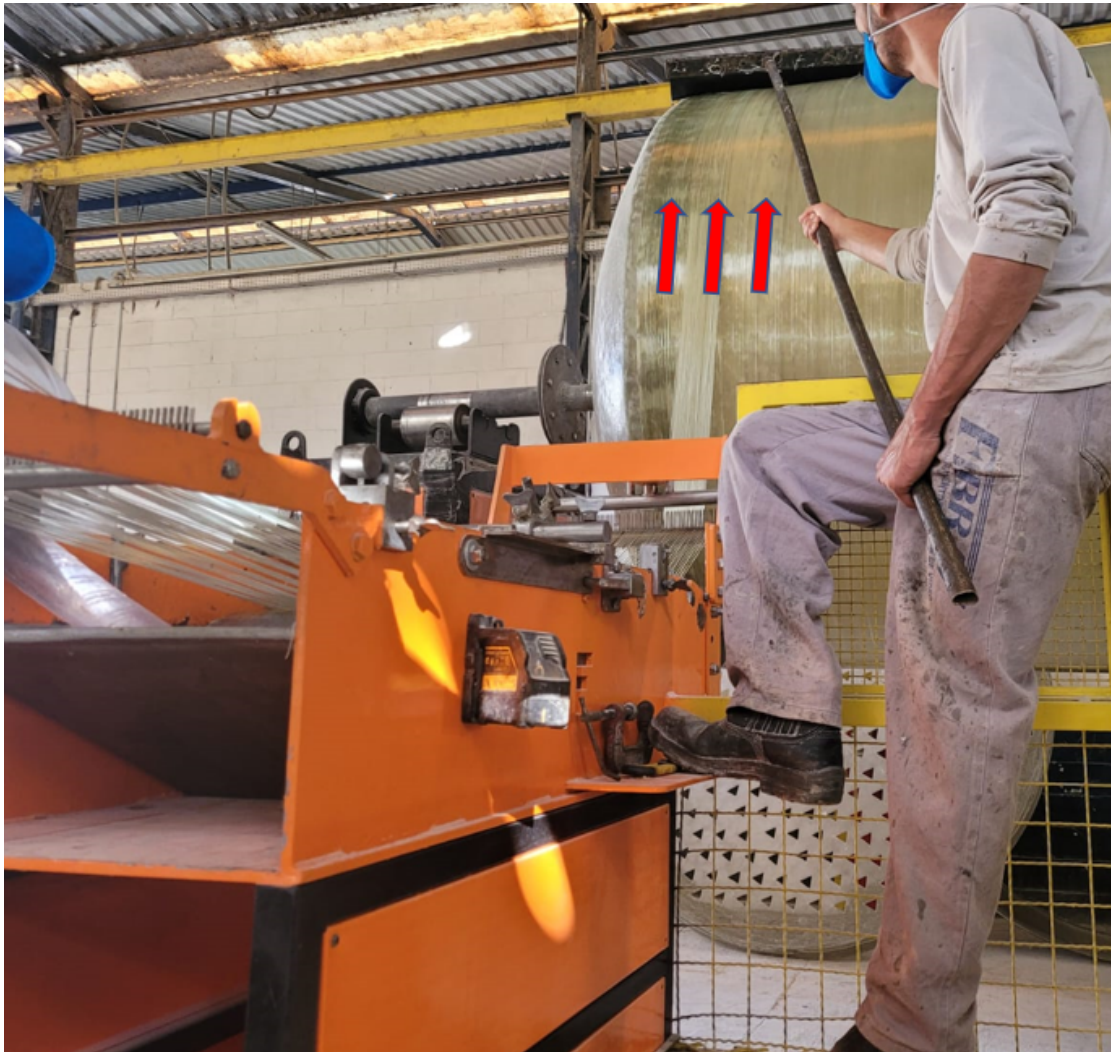
Figura 18– Direção preferencial da fibra.
