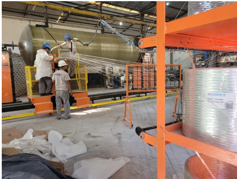
Figura 3 – Processo de fabricação Filament Winding
