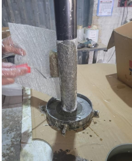
Figura 1 – Processo de fabricação Hand lay-Up
