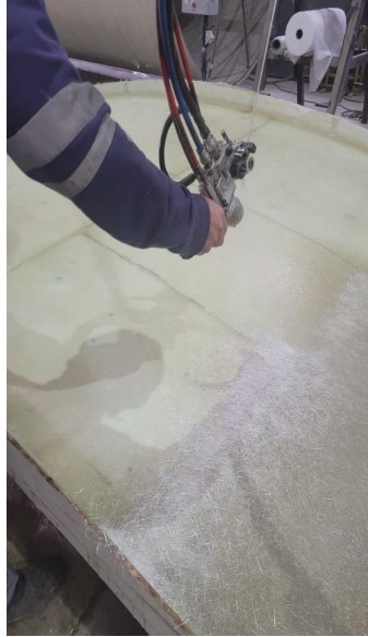
Figura 2 – Processo de fabricação Spray-up
