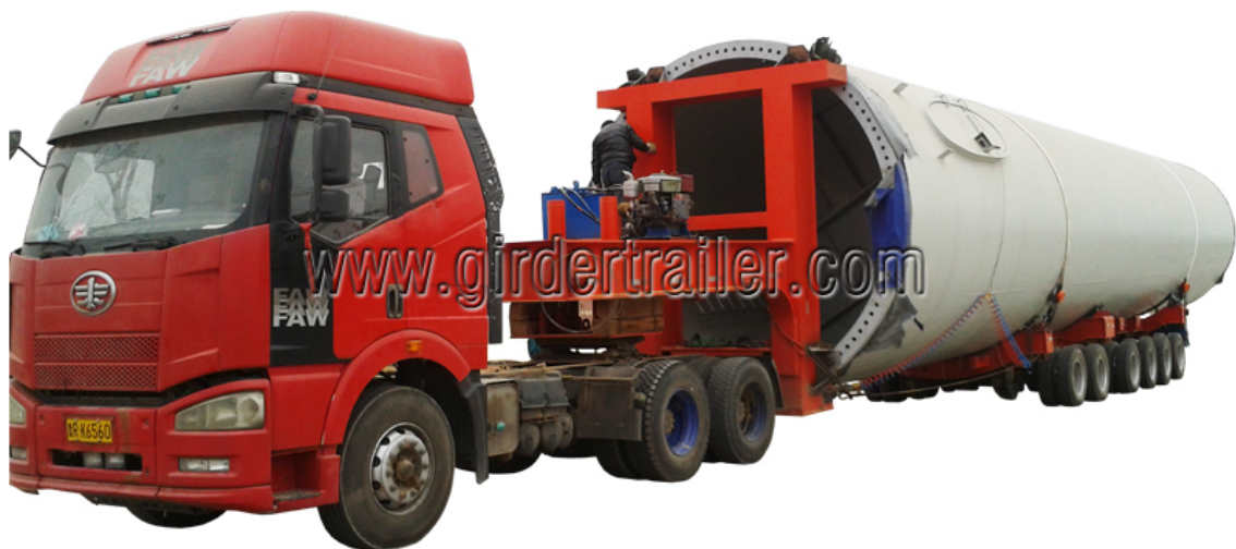
Figura 16 – Carreta com equipamento especial para o transporte de torres.
