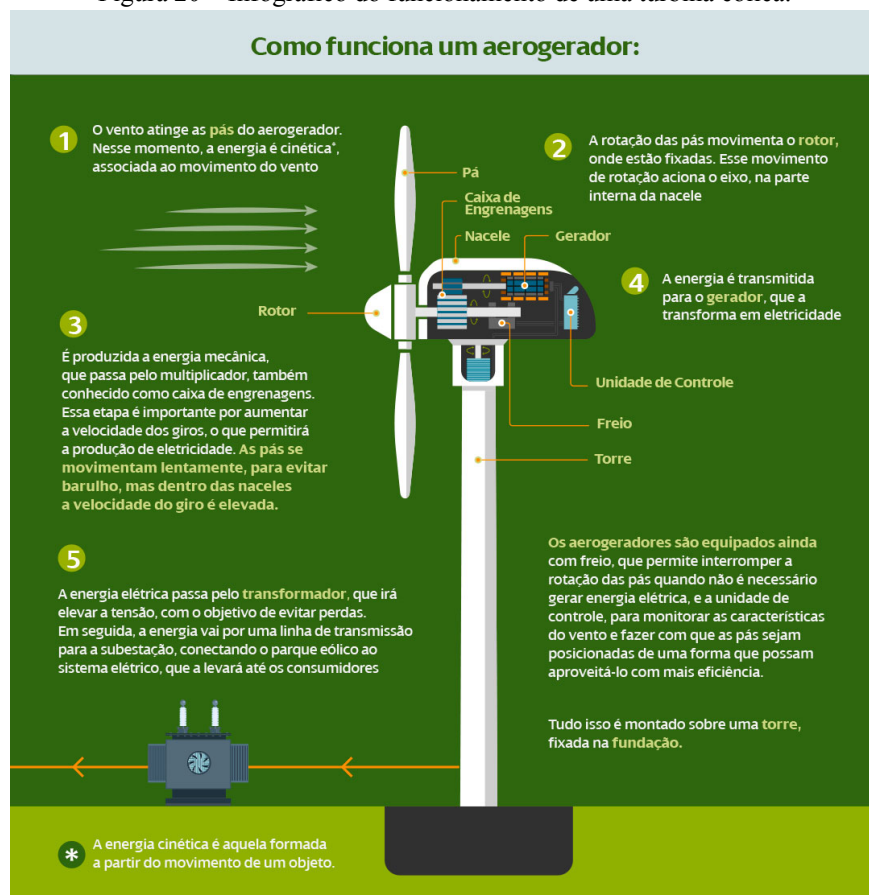
Figura 20 – Infográfico do funcionamento de uma turbina eólica.
