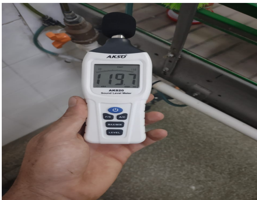
Figura 7: Medição do ruído antes da instalação do projeto mecânico
