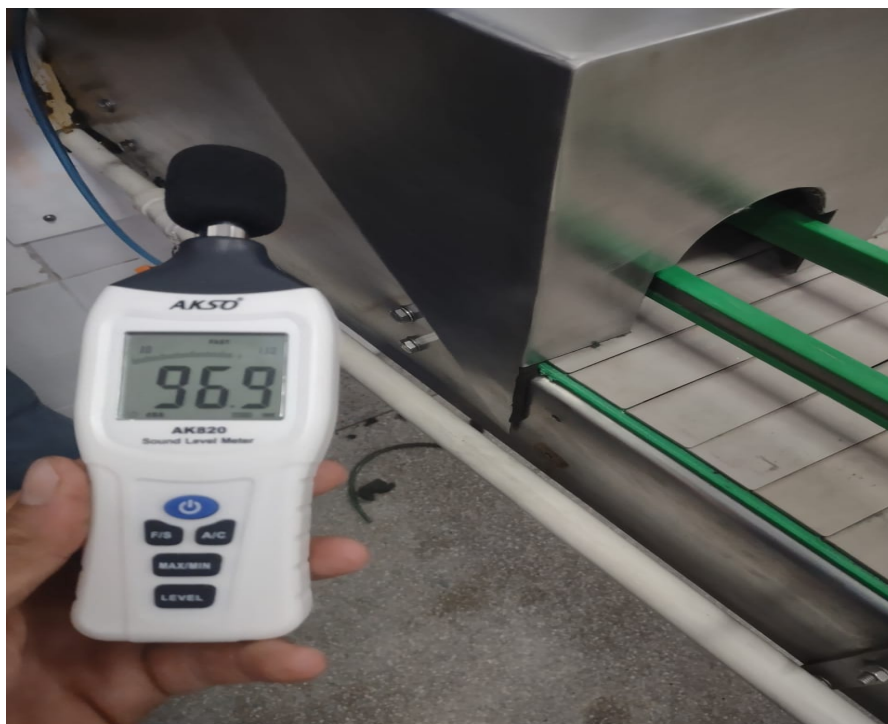
Figura 8: Medição do ruído depois da instalação do projeto mecânico.
