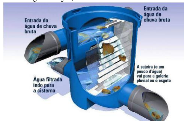
Figura 01 – Filtragem de água, através do filtro volumétrico
