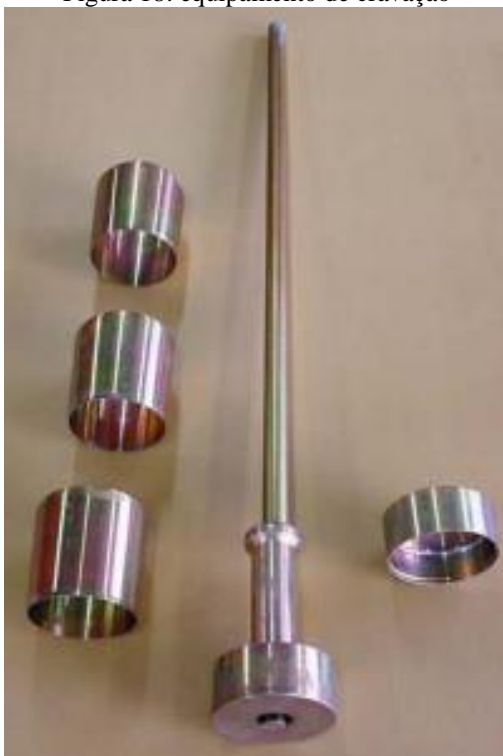
Figura 18: equipamento de cravação
