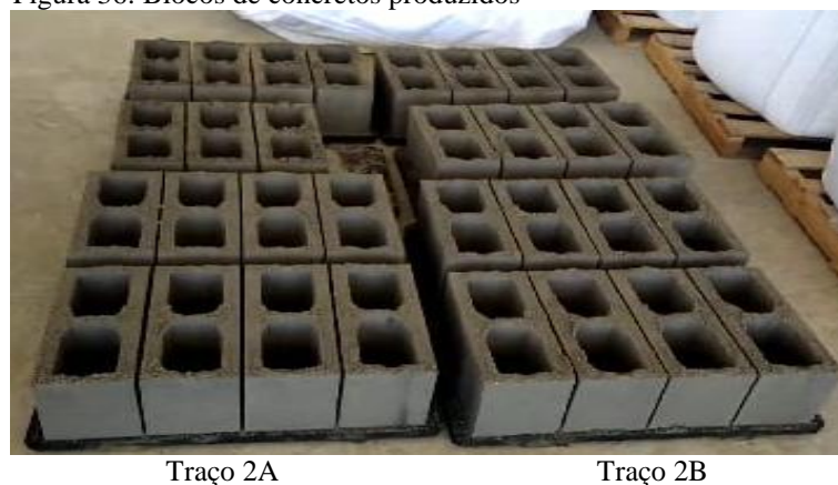
Figura 36: Blocos de concretos produzidos
