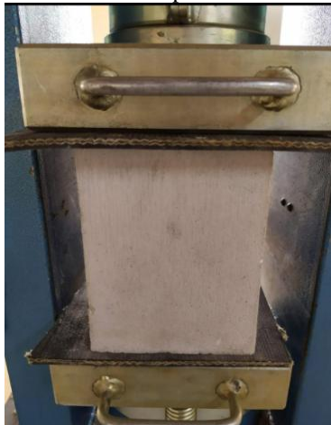
Figura 29: Ensaio de compressão axial dos blocos
