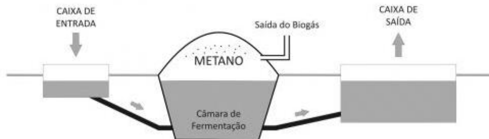
Figura 8 – Esquema básico de um biodigestor.
