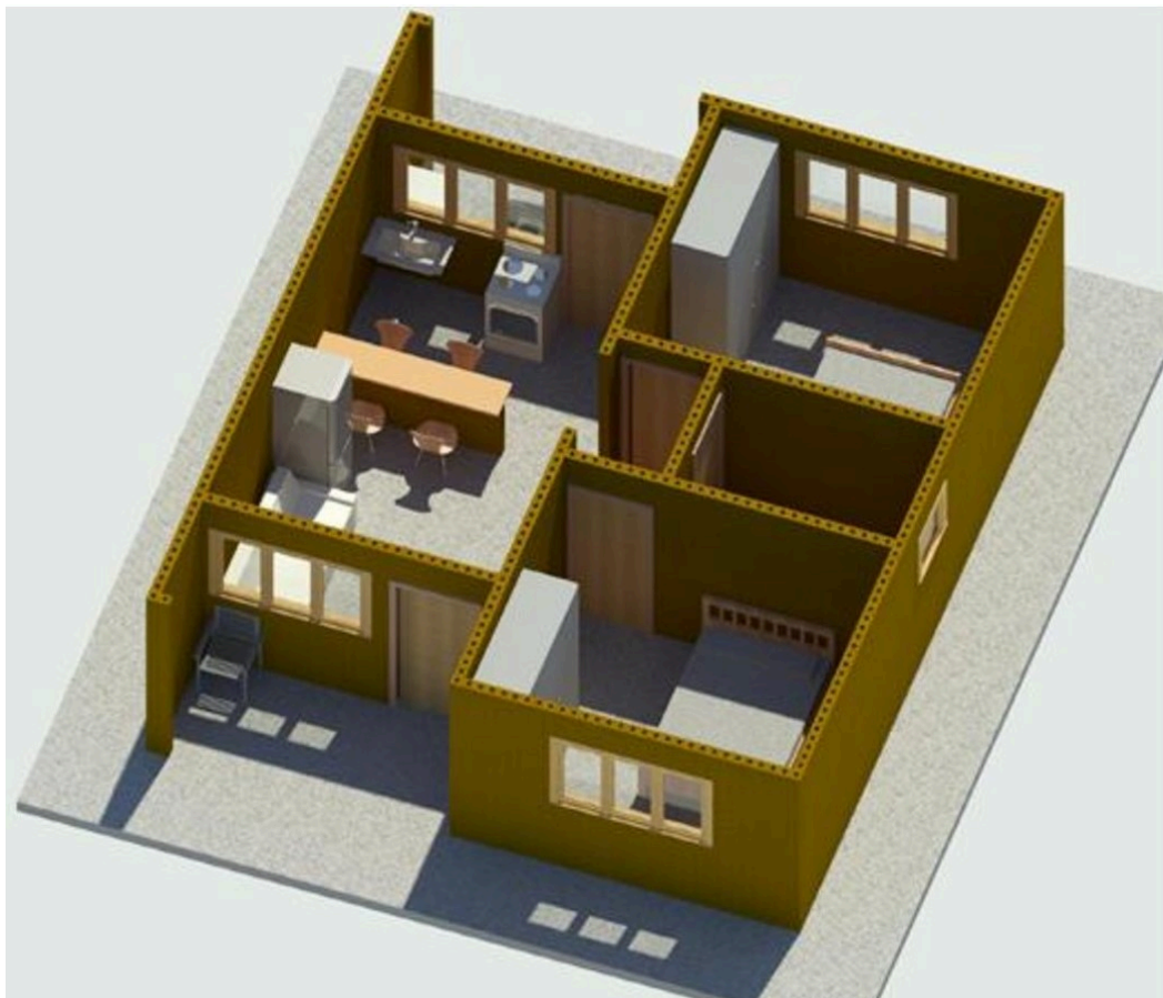
Figura 9 - Planta humanizada alvenaria tijolo solo-cimento
