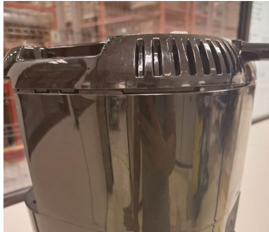
Figura 3 – Conjunto com problema, tem uma abertura entre corpo e base.
