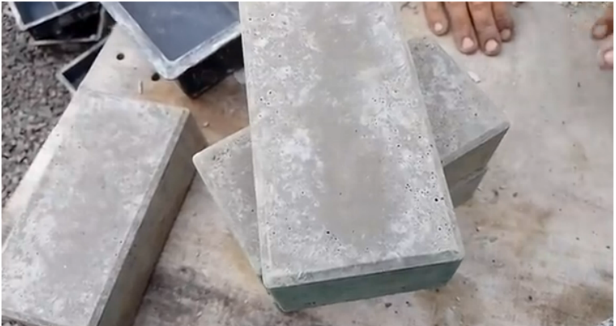
Figura 04 - bloco composto de cimento cpII, pó de vidro, brita 0 e água.
