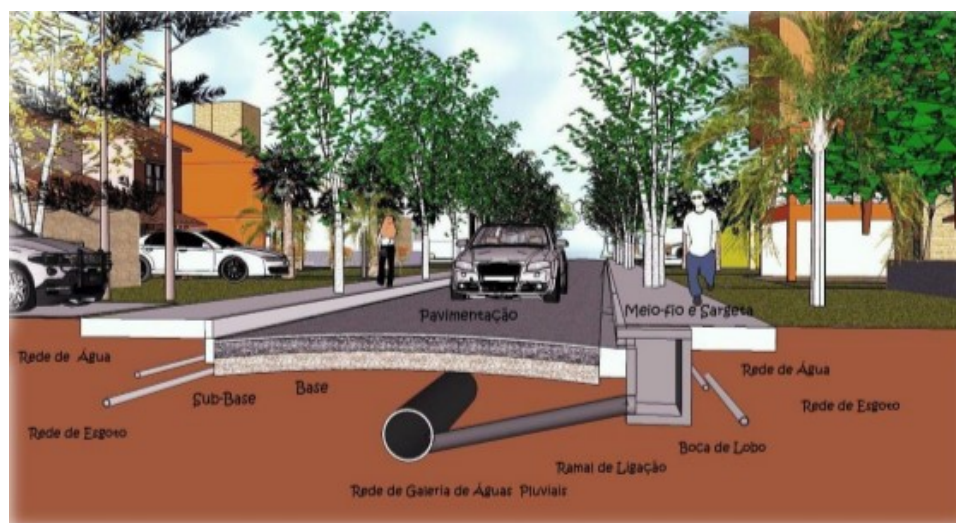
Figura 9 - Sistema de Microdrenagem
