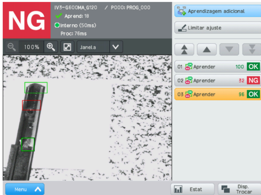
Figura 09 – ausência de sealer
