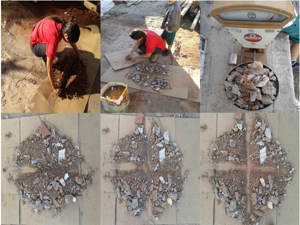
Figura 11 - Execução do método de quarteamo.
