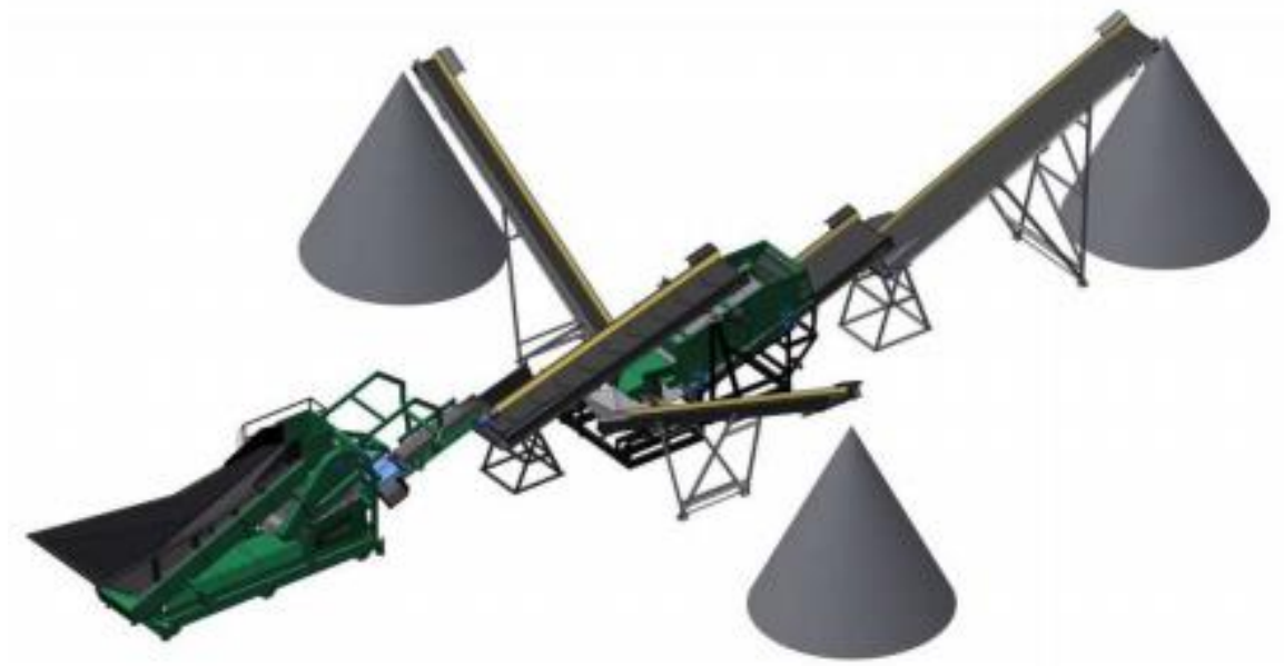
Figura 3 - Modelo de uma usina de tratamento semimóvel.
