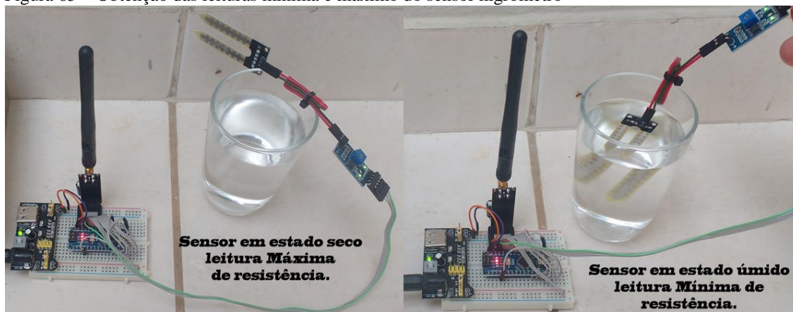
Figura 65 – Obtenção das leituras mínima e máximo do sensor higrômetro
