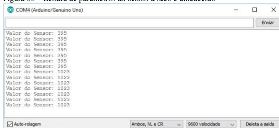
Figura 66 – Leitura de parâmetros do sensor à seco e umedecido
