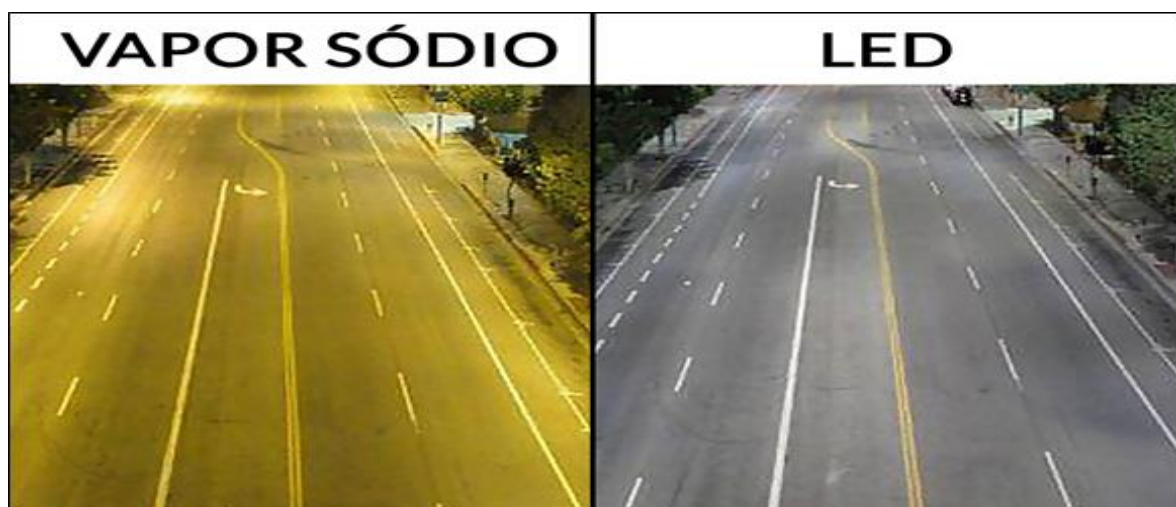
Figura 21 – Comparativo da luminária LED X Vapor de sódio
