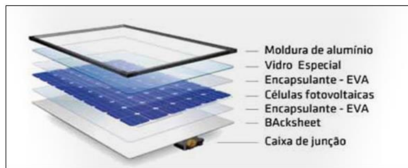
Figura 17 – Estrutura e Materiais - Placa Fotovoltaica
