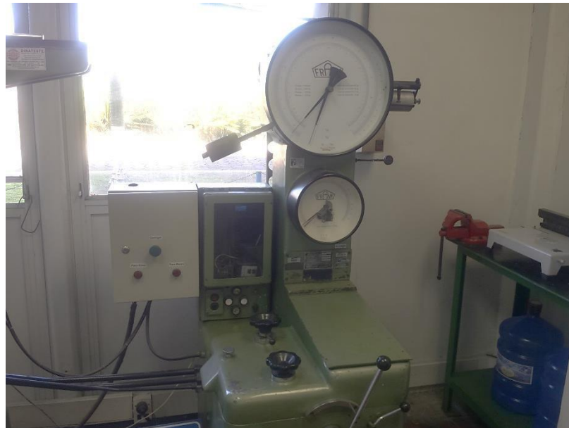
Figura 18: Máquina de tração e dobramento.
