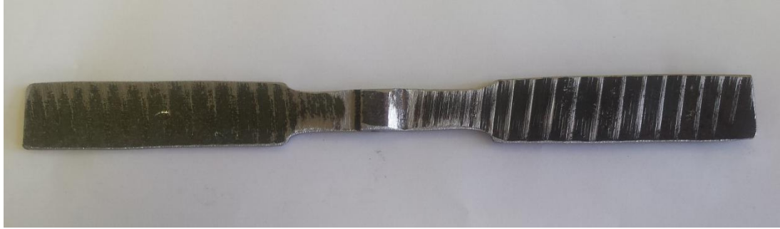
Figura 12: Imagem do corpo de prova para ensaio de tração.
