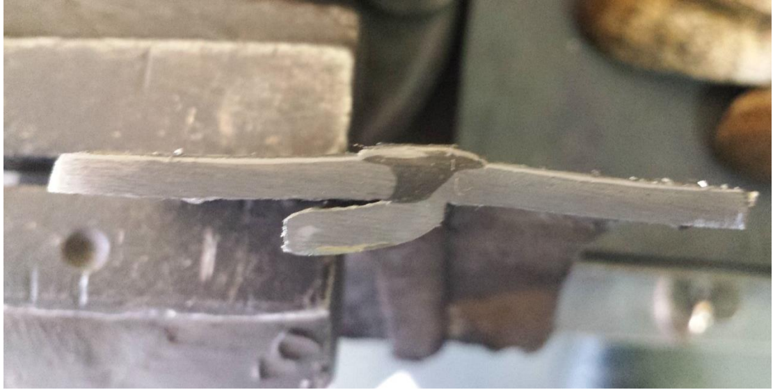
Figura 14: Peça para realizar macrografia.
