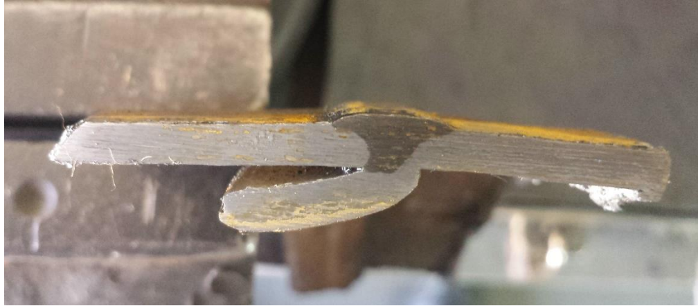
Figura 23: Macrográfia realizada com o Metal Cored
