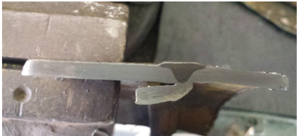
Figura 24: Macrográfia realizada com o arame sólido
