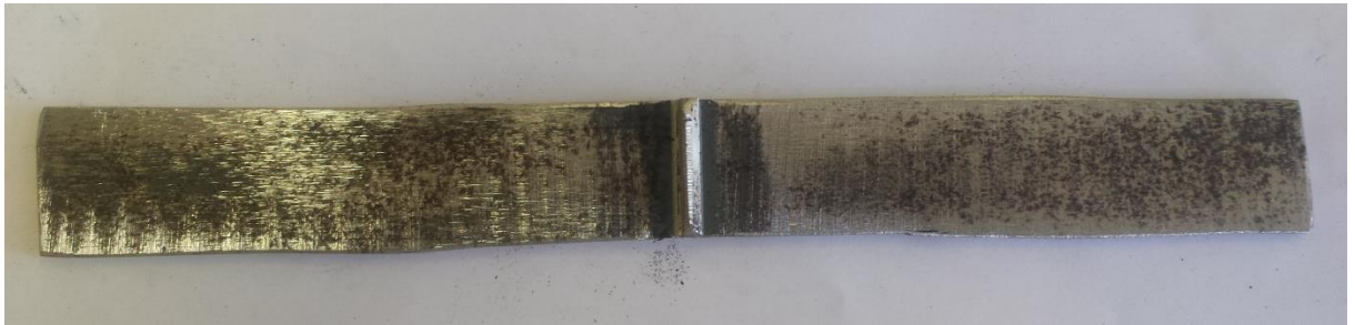
Figura 13: Corpo de prova para realizar o ensaio de dobramento
