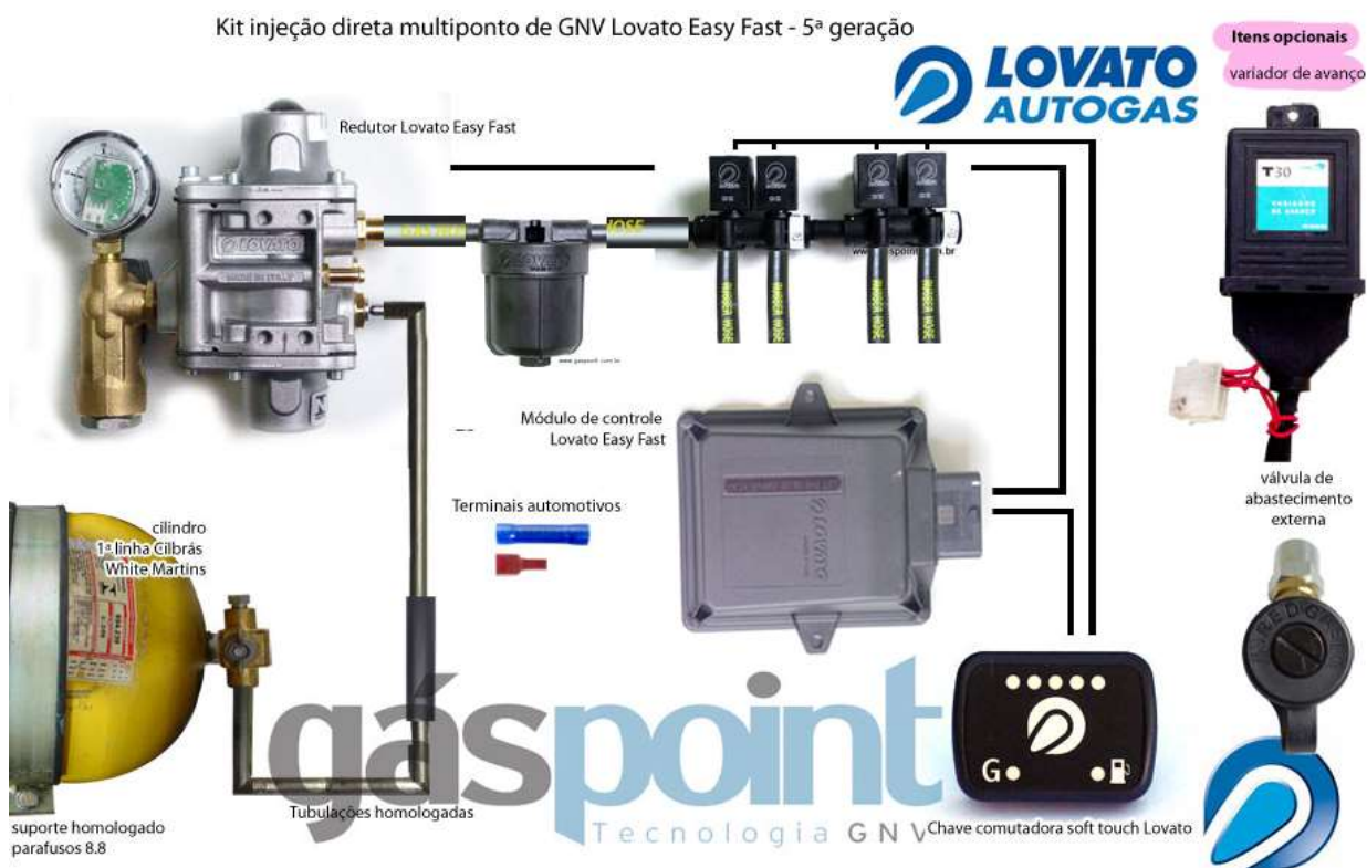
Figura 03: Esquemática dos itens do kit GNV de 5ª geração LOVATO.
