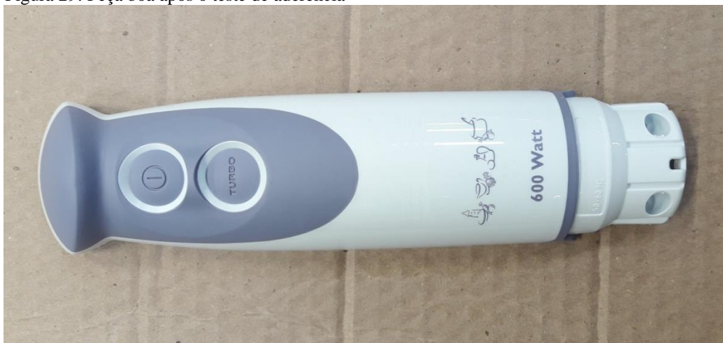
Figura 29: Peça boa após o teste de aderência
