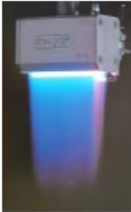
Figura 14: Bico da chama por tratamento com flambagem
