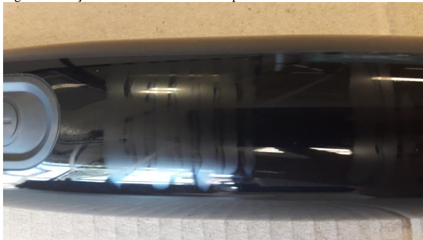
Figura 25: Peça defeituosa com marca do plasma
