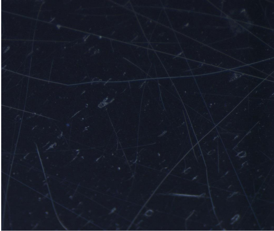
Figura 27: Superfície da peça antes do tratamento com plasma
