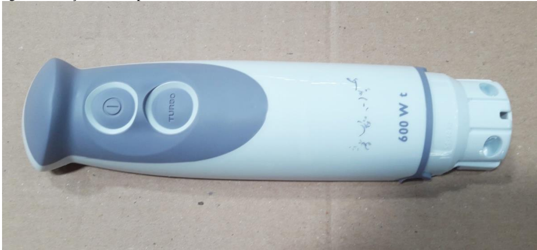
Figura 30: Peça falhada após o teste de aderência
