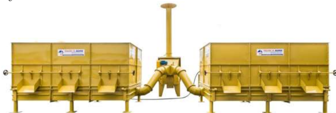
Figura 08 – Secador estático Palini&Alves vista frontal
