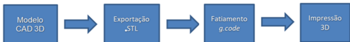
Figura 7: Fases do projeto de impressão 3D
