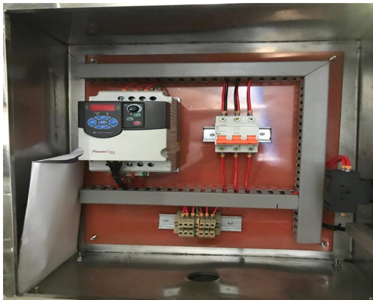
Figura 16: Painel da máquina produtora de queijo Minas frescal.
