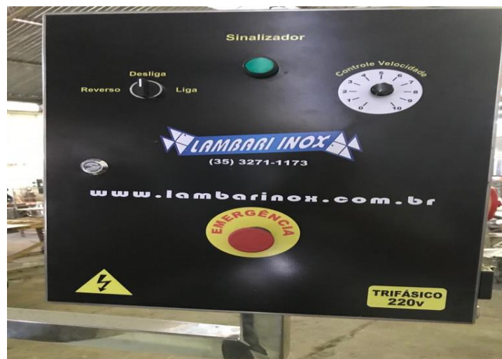
Figura 15: Painel da máquina produtora de queijo Minas frescal.
