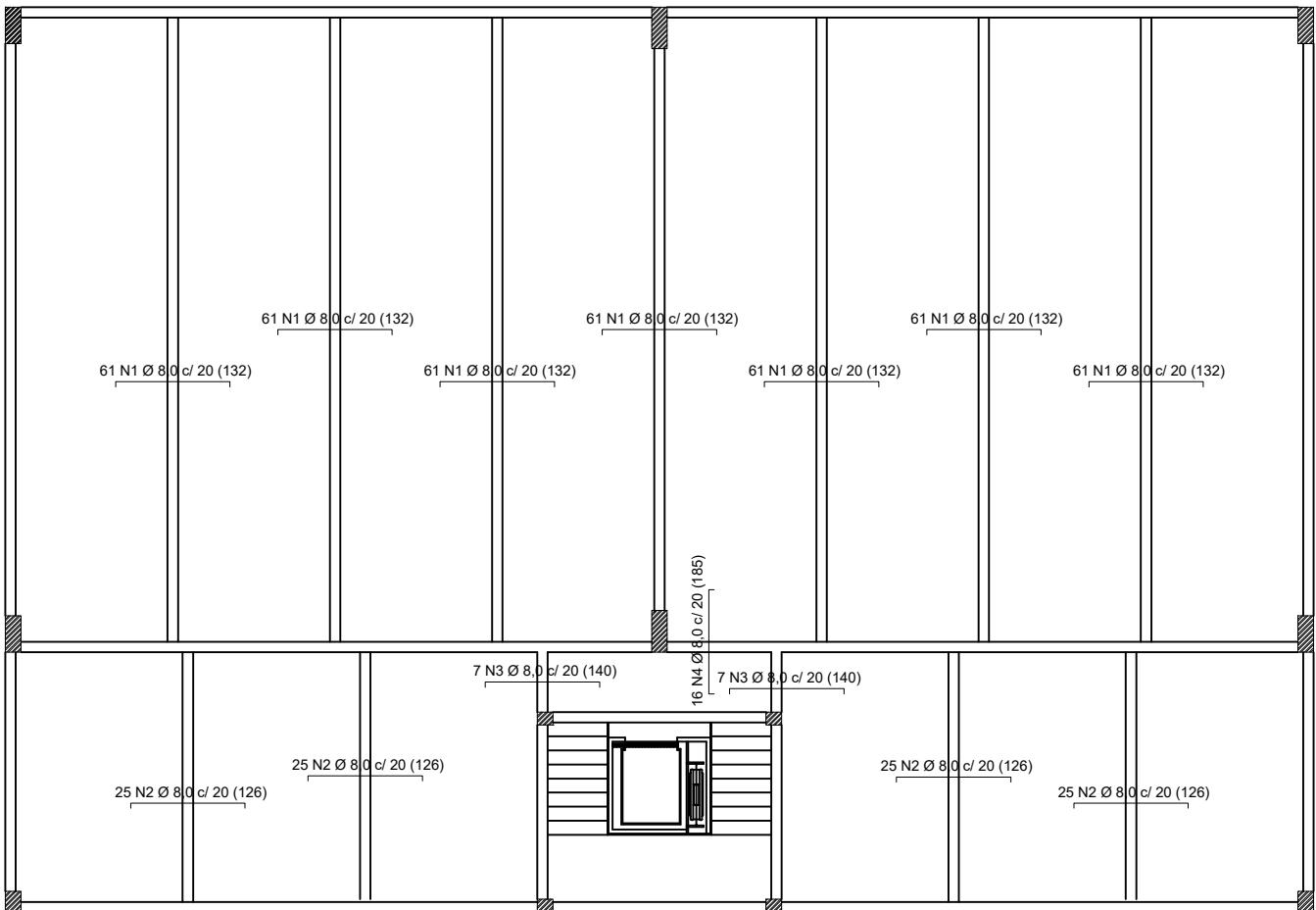
FIGURA 02 - DETALHAMENTO ARMADURA NEGATIVA - LAJE MISTA "STEEL DECK"
