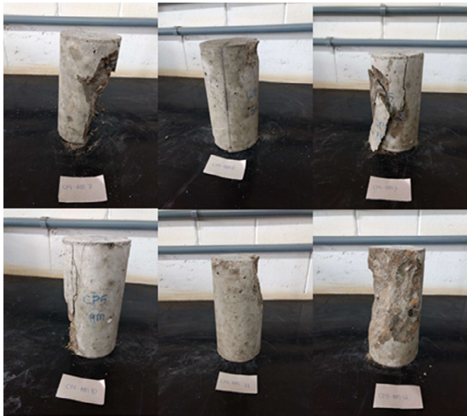
Figura 36-Corpos de Provas rompidos com Areia Média e CPV aos 28 dias
