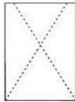
Figura A.1 – Tipo A – Cônica e cônica afastada 25 mm do capeamento
