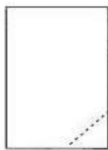
Figura A.6 – Tipo F – Fraturas no topo e/ou na base abaixo do capeamento
