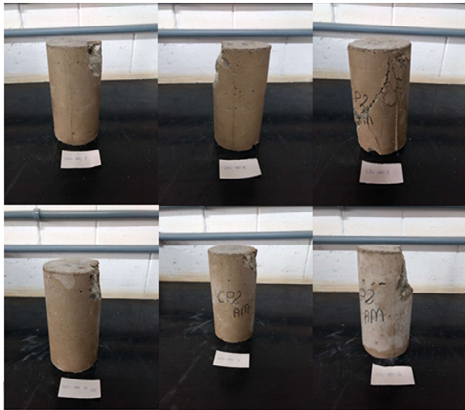
Figura 32-Corpos de Provas rompidos com Areia Média e CII aos 28 dias
