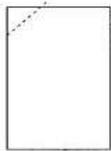
Figura A.6 – Tipo F – Fraturas no topo e/ou na base abaixo do capeamento
