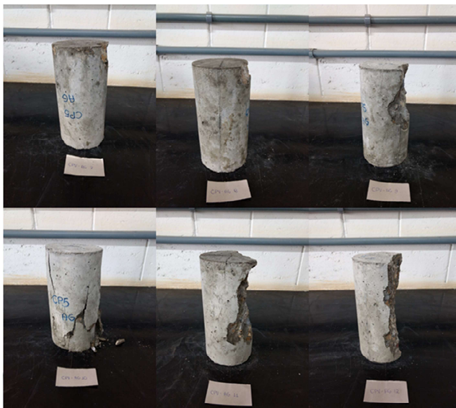
Figura 37-Corpos de Provas rompidos com Areia Grossa e CPV aos 28 dias
