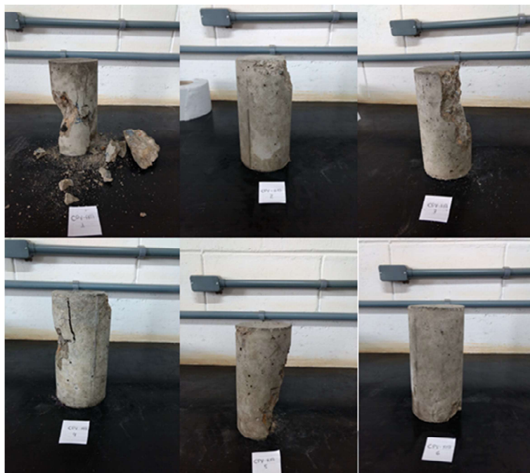
Figura 34-Corpos de Provas rompidos com Areia Média e CPV aos 14 dias
