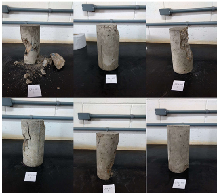
Figura 35- Corpos de Provas rompidos com Areia Grossa e CPV aos 14 dias
