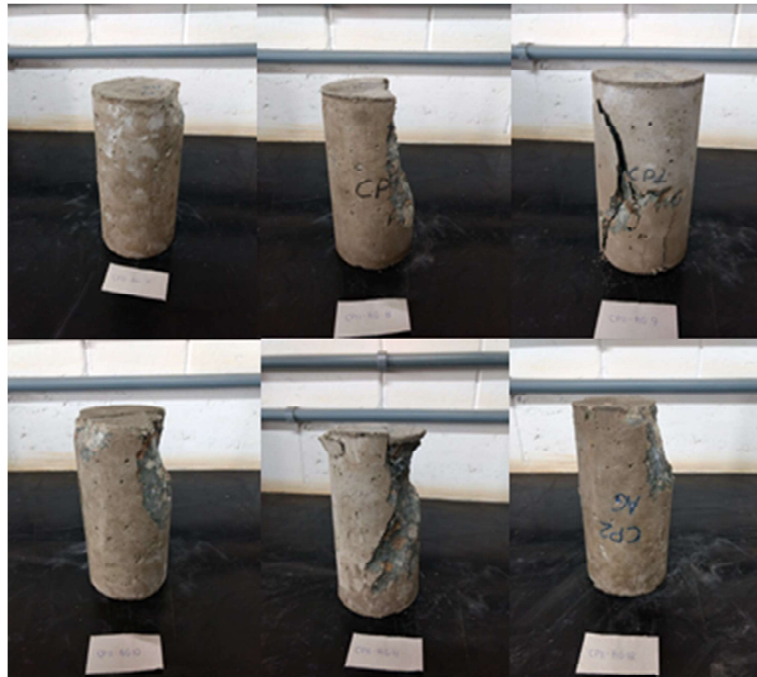
Figura 33- Corpos de Provas rompidos com Areia Grossa e CPII aos 28 dias
