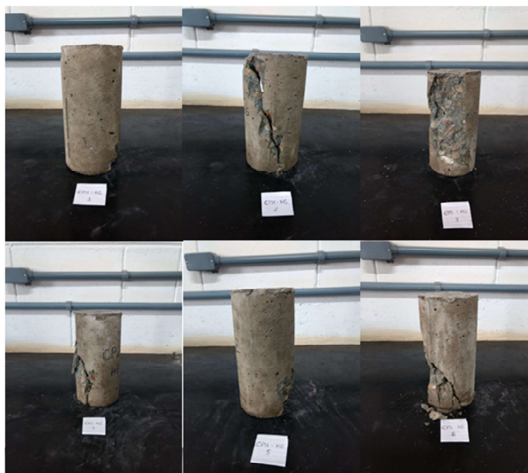
Figura 31-Corpos de Provas rompidos com Areia Grossa e CPII aos 14 dias
