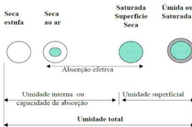
Figura 3-Representação esquemática das condições de umidade do agregado para concreto
