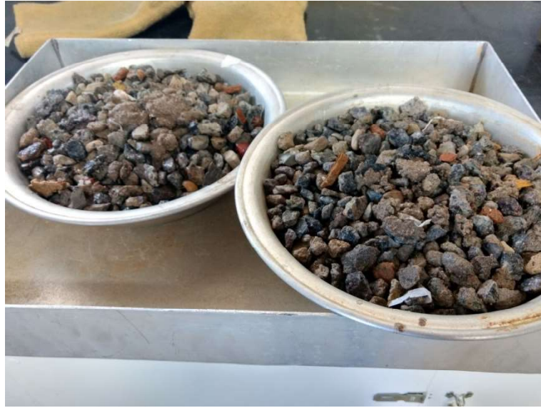
Figura 29-Amostra Reciclada após lavagem
