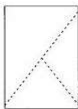
Figura A.4 – Tipo D – Cônica e cisalhada
