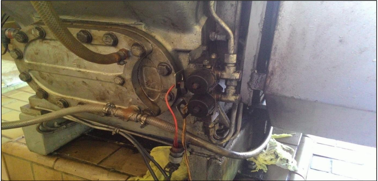
Figura 7. Válvulas solenoides do pistão
