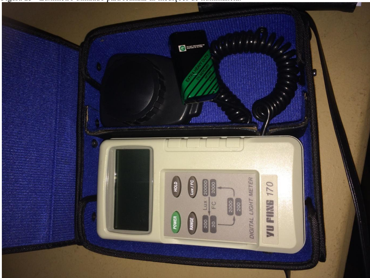
Figura 23 - Luxímetro utilizado para realizar as medições de iluminância.
