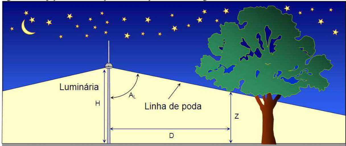
Figura 16 - Projeção da desobstrução da iluminação no sentido longitudinal
