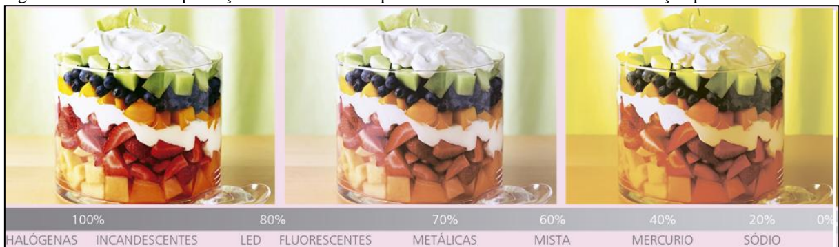
Figura 03 - Índice de Reprodução de Cores das lâmpadas utilizadas no sistema de iluminação pública
