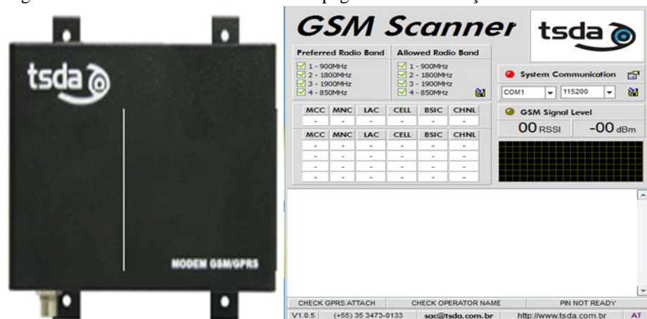
Figura 13 - Modem TSDA GPRS TC65 e pagina de comunicação serial
