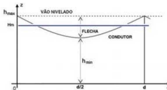
Figura 4: Altura média dos condutores.
