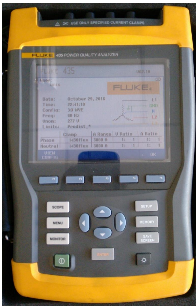
Figura 30 – Analisador de Qualidade de Energia Elétrica FLUKE, modelo 435.
