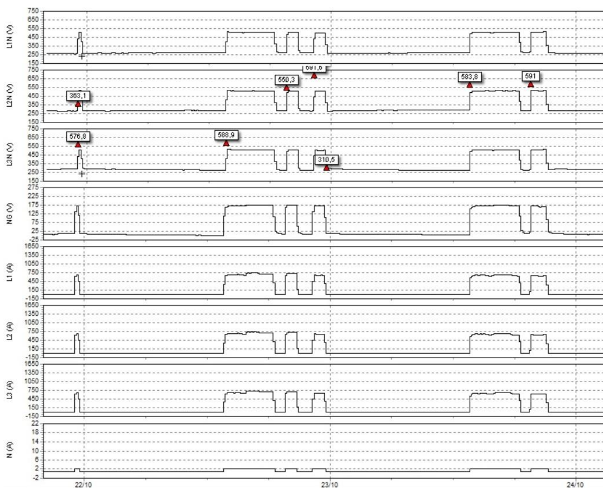
Figura 32 – Amostragem dos níveis de tensão em 200 milissegundos (12 ciclos) encontrados.
