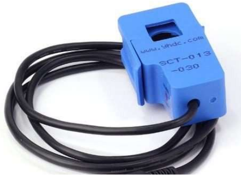
Figura 9 – TC de 100A : 50mA adotado para testes
