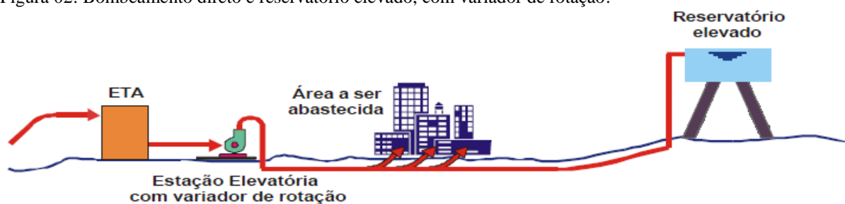
Figura 02: Bombeamento direto e reservatório elevado, com variador de rotação.
