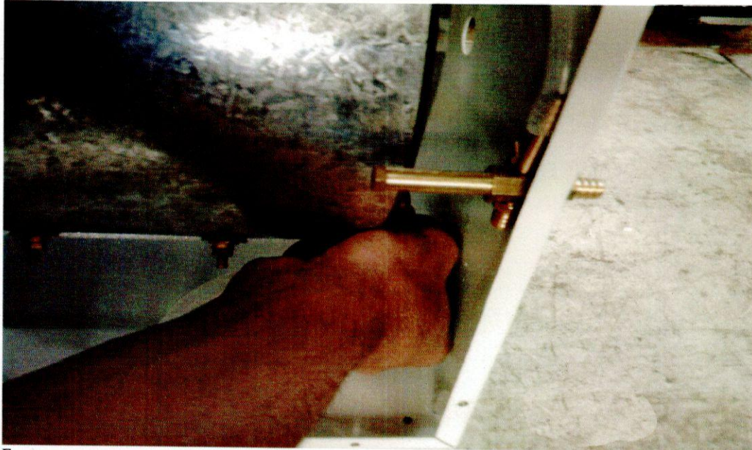
Figura 1 - acoplamento do tubo de silicone ao cotovelo da cuba inox
