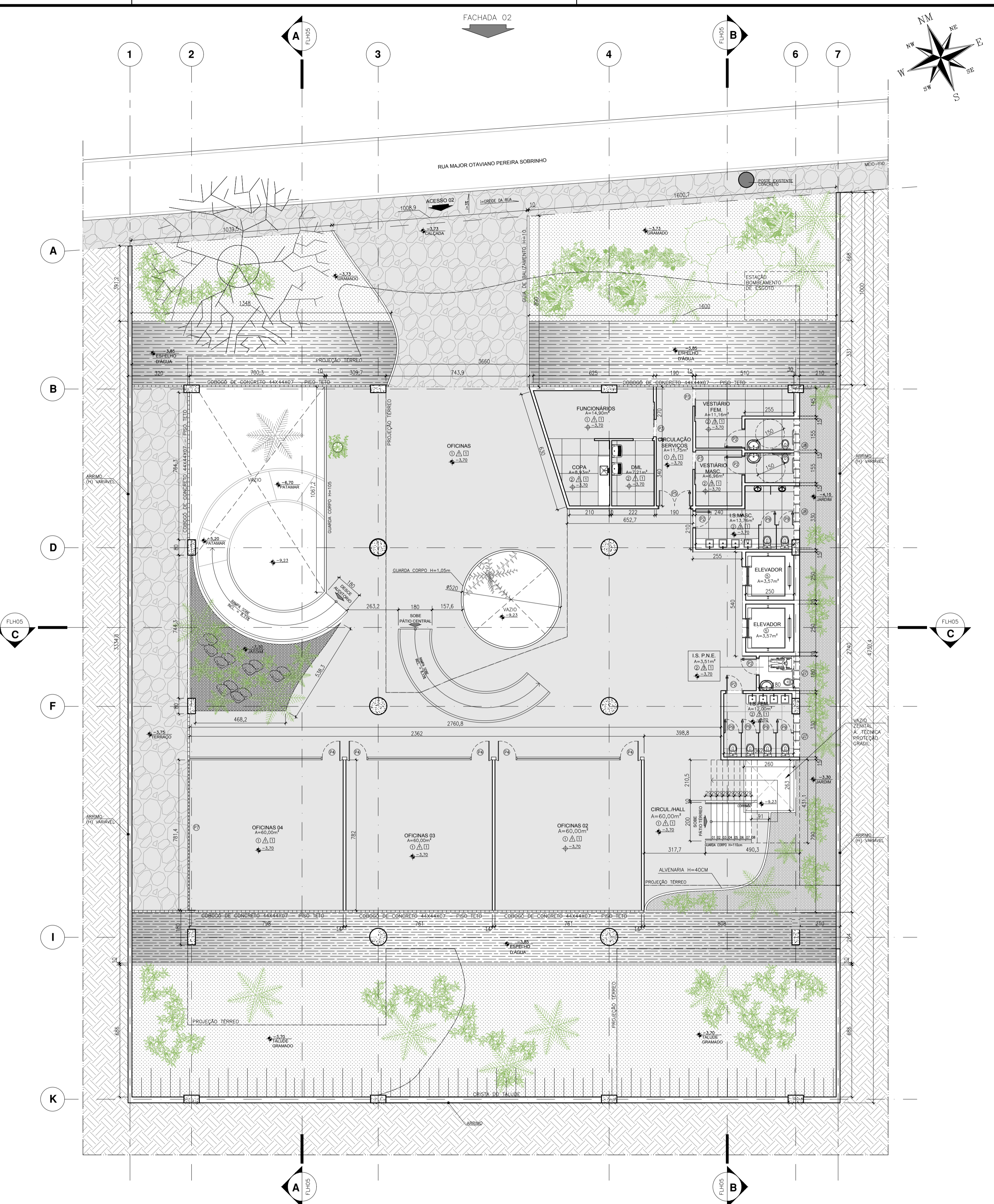
05 PLANTA SUBSOLO 02 esc: 1:125 A=952m 2
