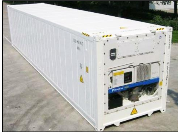
Figura 50: Vista do Contêiner Reefer 40 pés
