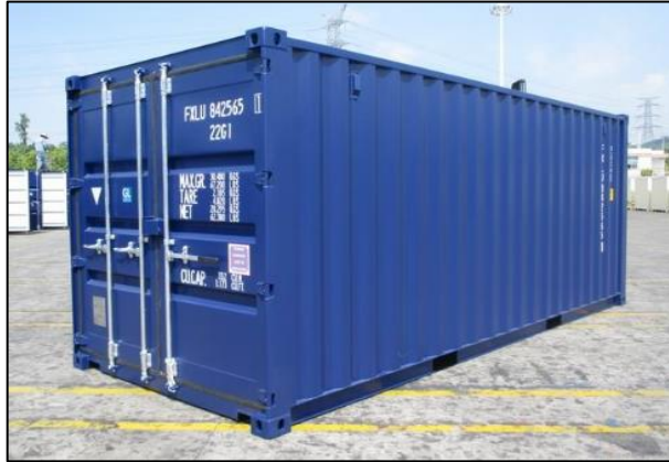
Figura 45: Vista do Contêiner Dry Box 20 pés
