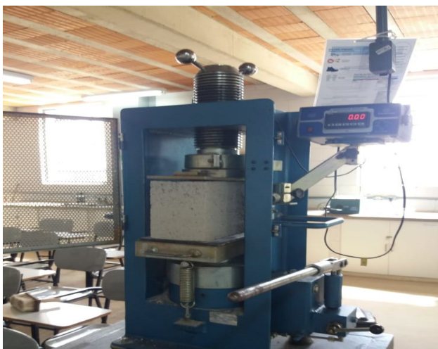
Figura 14: Capeamento do bloco com chapas de neoprene. Figura 15: Amostra rompida.
