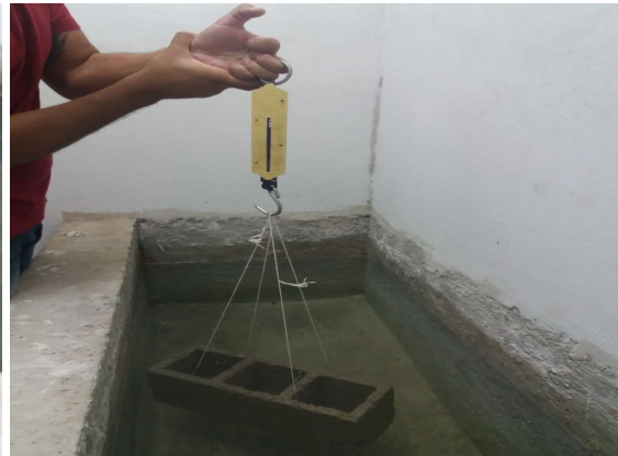
Figura 13: Pesagem da amostra imersa.
