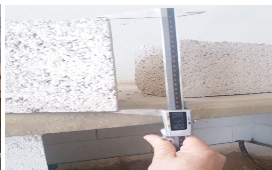
Figura 07: Medição da altura
