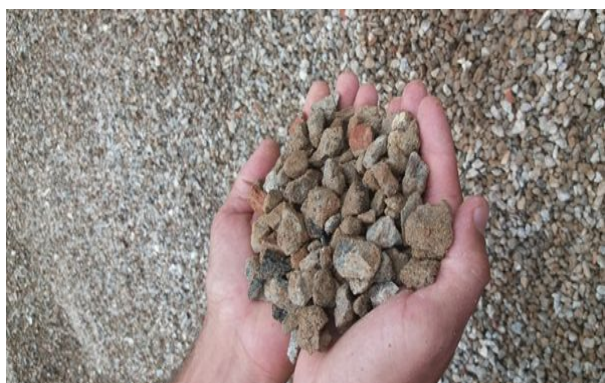
Figura 02 - Brita proveniente à moagem do RCD.
