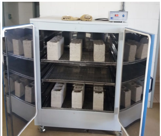
Figura 11: Amostras na estufa
