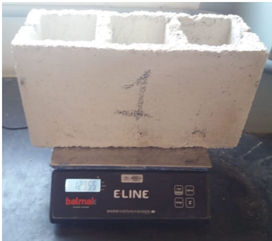
Figura 10: Pesagem das amostras
