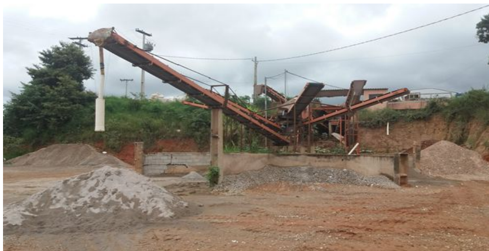
Figura 01 - Processo de triagem e moagem do RCD
