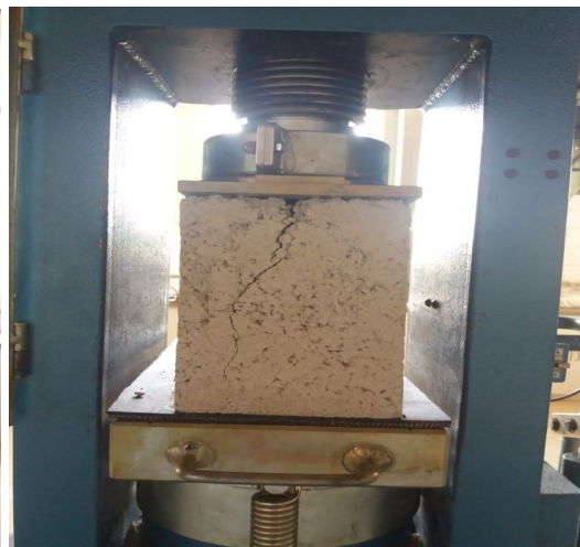
Figura 14: Capeamento do bloco com chapas de neoprene. Figura 15: Amostra rompida.
