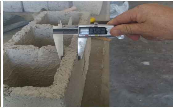
Figura 09: Medição da espessura parede
